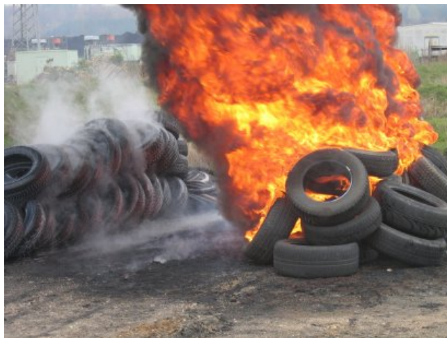
Die Flammen griffen nicht auf den mit FIRESORB® begelgten Reifenstapel über.
