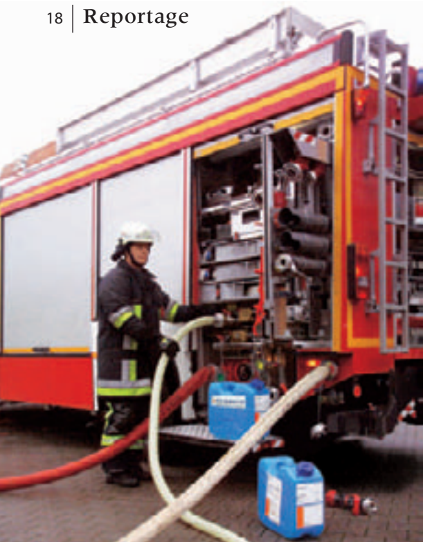
FIRESORB® im Einsatz. Die Beimischung erfolgt über eine wasserangetriebene Dosierpumpe.
